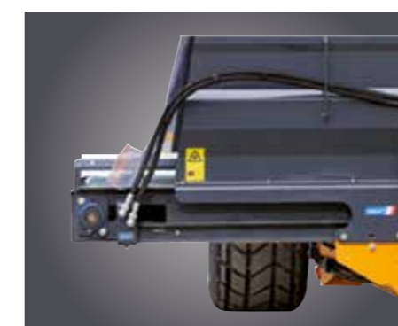
Вынос конвейера раздачи гидравликой
