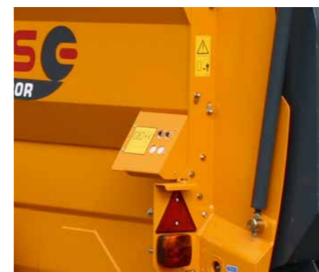
2-й пост управления Управление задней подборной дверью во время загрузки для экономии времени.
