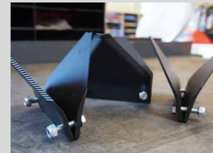
Изогнутые ножевые секции для сохранения абразивности разматывателя.
