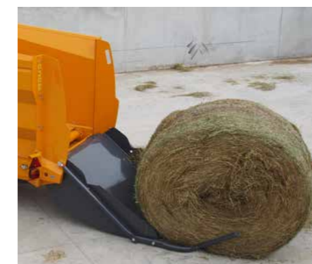
Загрузочная дверь на 1200 кг Дверь оснащена 2-м гидроцилиндром для загрузки тюков сенажа в пленке.
